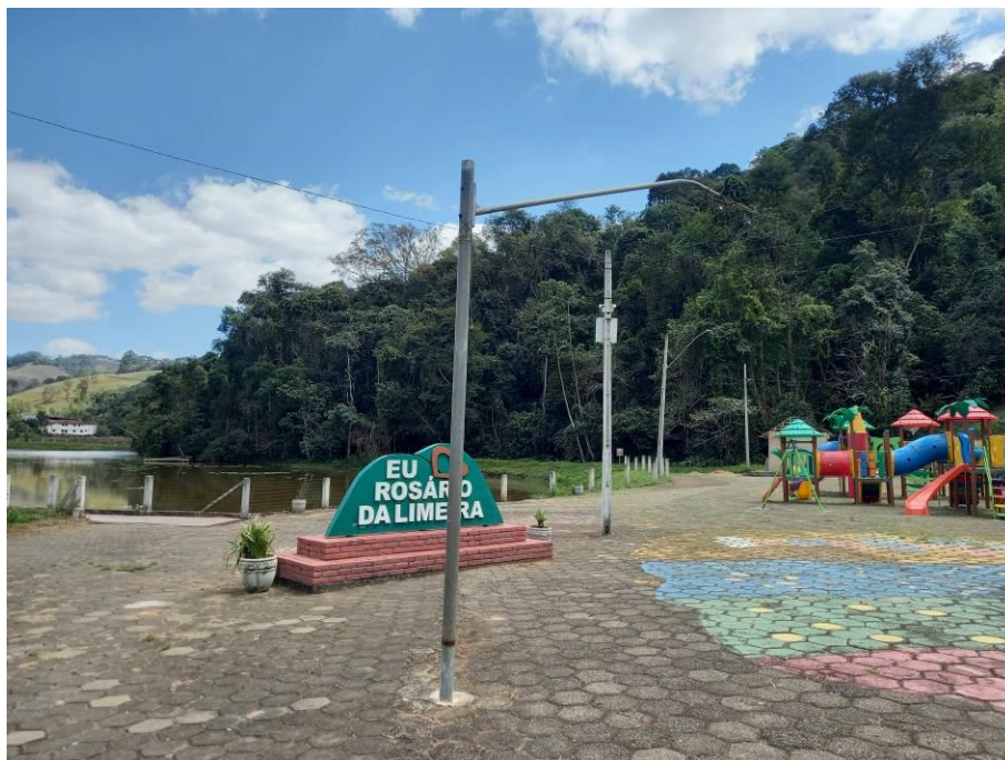
Foto 21: Poste metálico com fiação embutida em primeiro plano, e poste de concreto com fiação aérea com câmeras de segurança, em segundo plano. Autoria: Alexandra Sales | Data: 16/09/2025
